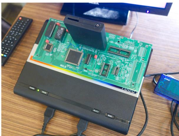
**Das 7800XM (hier ohne Pokey-Chip) wurde auf dem ejagfest weiter getestet. Das Gehäuse ist bereits fertig produziert und wartet auf die finalisierte Platine.**
