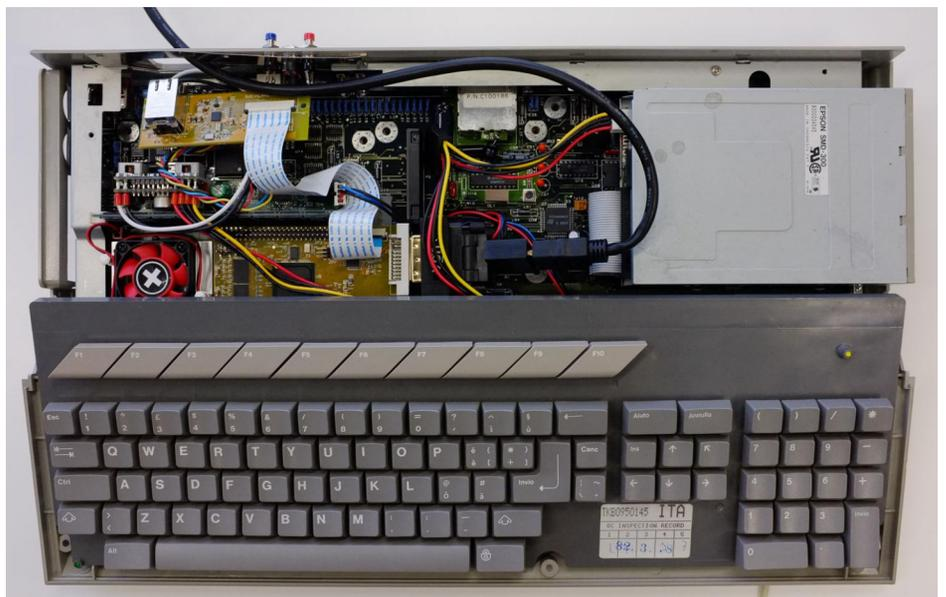
**Der SuperVidel im eingebauten Zustand. Aufgrund der knappen Abmessungen im Originalgehäuse müssen Festplatte und Festplattenhalterung weichen (hier ersetzt durch ein SSD-Steckmodul). Ein HDMI-Adapter mit Verlängerungskabel führt das Video-Signal durch die ehemalige Kaltgerätebuchse nach draussen. Das SVEthLANa Erweiterungsboard ist noch nicht endgültig platziert.**
