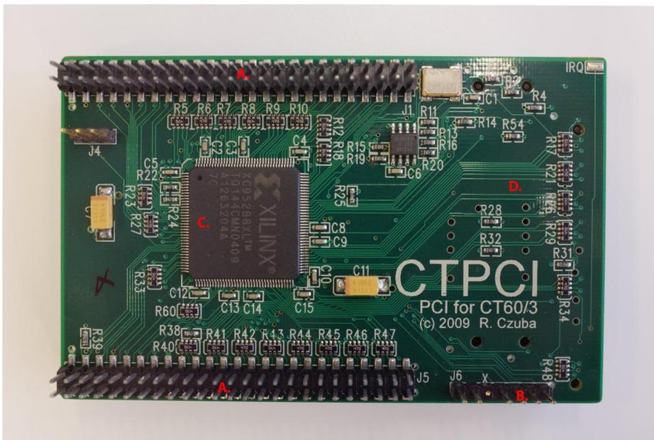
**Die CTPCI Hauptkarte. A. Durchgeschleifter CT6x-Bus, B. Anschluss für JTAG-Programmierskabel (FPGA-Konfiguration), D. (nicht sichtbar/Unterseite) Anschlüsse für IDE-Kabel zum Anschluss der PCI-Backplane**
