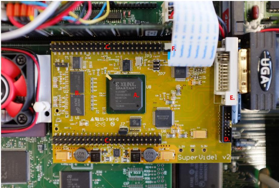
**Der SuperVidel im eingebauten Zustand. A. FPGA-Chip für die Grafik- und Ethernet-Routinen, B. 128 MB DDR2-Grafikspeicher, C. Durchgeschleifter CT6x-Bus, D. Anschluss für JTAG-Programmierskabel (FPGA-Konfiguration), E. DVI-I Anschluss, F. Flachkabel-Anschluss für SVethLANa Tochterboard**
