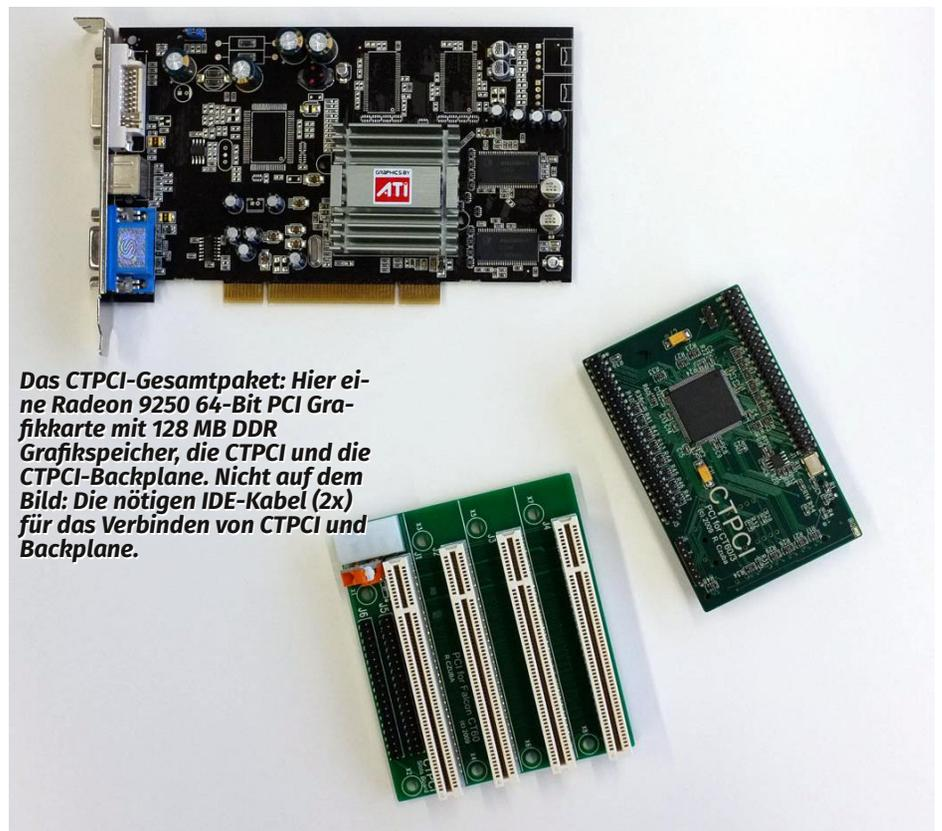
**Das CTPCI-Gesamtpaket: Hier eine Radeon 9250 64-Bit PCI Grafikkarte mit 128 MB DDR Grafikspeicher, die CTPCI und die CTPCI-Backplane. Nicht auf dem Bild: Die nötigen IDE-Kabel (2x) für das Verbinden von CTPCI und Backplane.**
