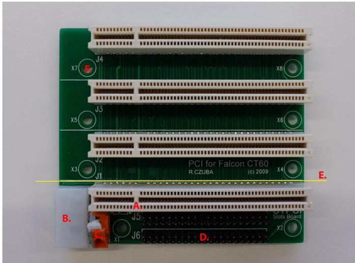
**Die CTPCI PCI-Backplane zur Aufnahme der PCI-Karten. A. PCI-Slot (64-Bit), B. Anschluss für Molex-Stecker (5V/12V Stromversorgung), C. Anschluss für 3.3V Stromversorgung, D. Anschlüsse für IDE-Kabel zum Anschluss an die CTPCI, E. Mögliche Trennlinie zum Zuschneiden einer 1-Slot PCI-Aufnahme (für den Einbau im Originalgehäuse), F. Montagelöcher für den Einbau im Tower**
