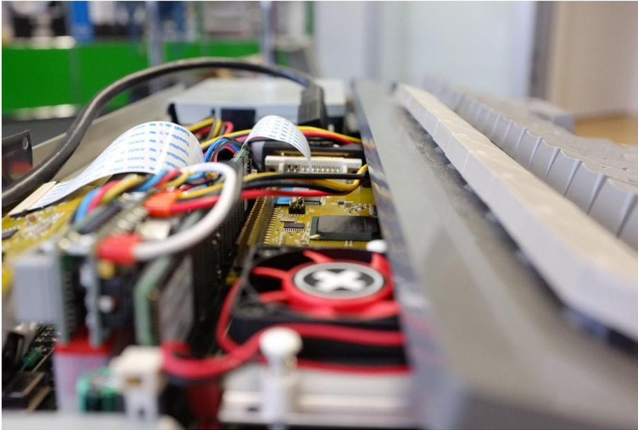
**Knapp geht es beim Einbau ohne die CT060-Extender, die die CT060 ca. 5cm weiter nach hinten brächten, trotzdem zu. Damit am durchgeschleiften CT060-Bus (hier der rechte) kein Kurzschluss erzeugt wird, muss die Tastaturplatine von hinten mit Klebeband abgelebt und damit vom Konnektor isoliert werden.**
