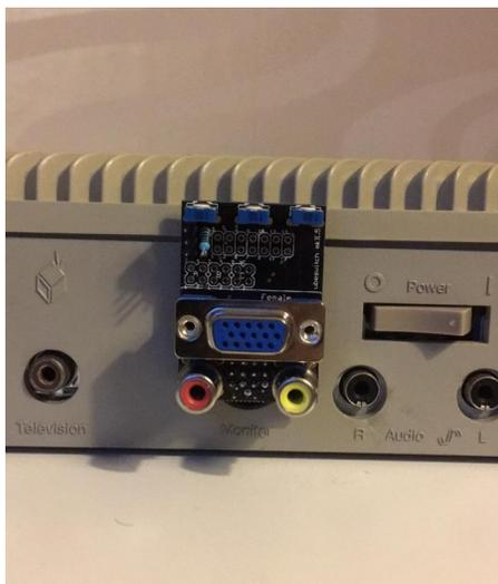
Qualitativ hochwertiger ist natürlich der Anschluss an einen Monitor. Ein kleiner Adapter namens UBE stellt unkompliziert die Verbindung zu einem VGA-Display her. Die kleine Platine mit dem VGA-Anschluss wird einfach auf die Monitor-Buchse gesteckt und schon finden auch ST und STE Anschluss an VGA-Displays. Mit den meisten Displays ist allerdings nur die Darstellung der hohen ST-Auflö-
