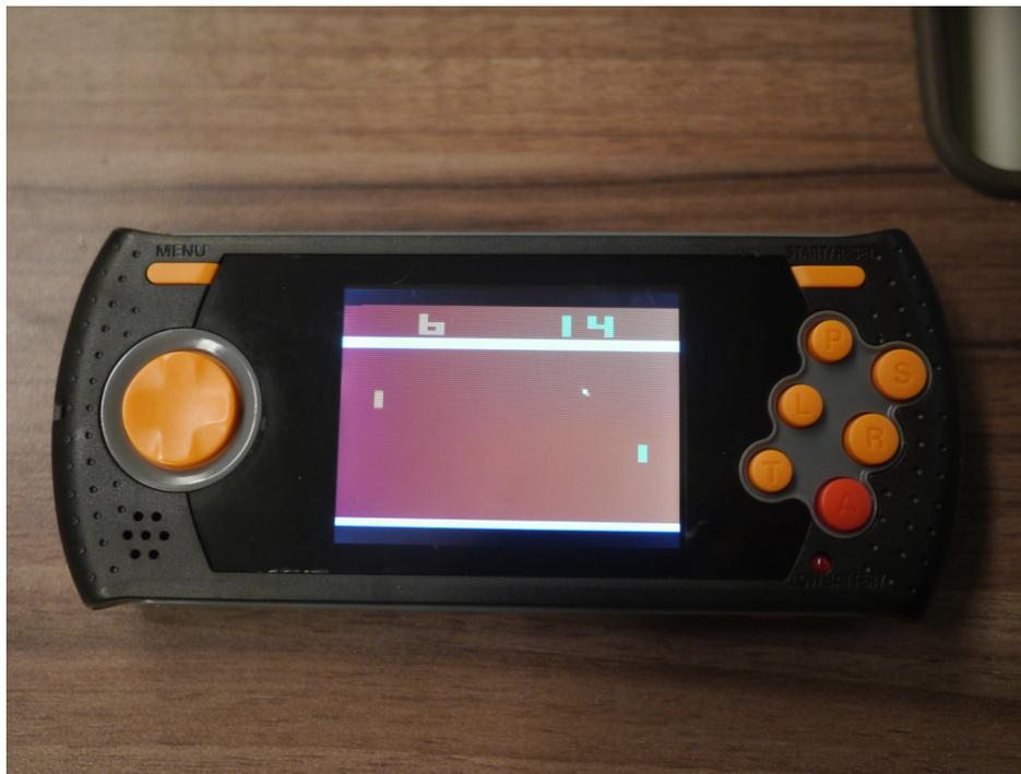
**Nur eine Feuertaste für das Flashback – die anderen Buttons bedienen die diversen Schalter der VCS-Konsole.**
